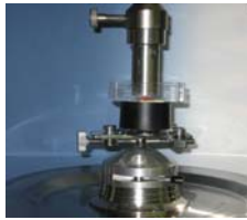
Abb. 1: Versuchsaufbau mit selbst konstruierten Halterungen – starre Befestigung der Sekundärkrone, bewegliche Verankerung der Primärkrone (Foto: privat) (Versuchsaufbau.jpg)
